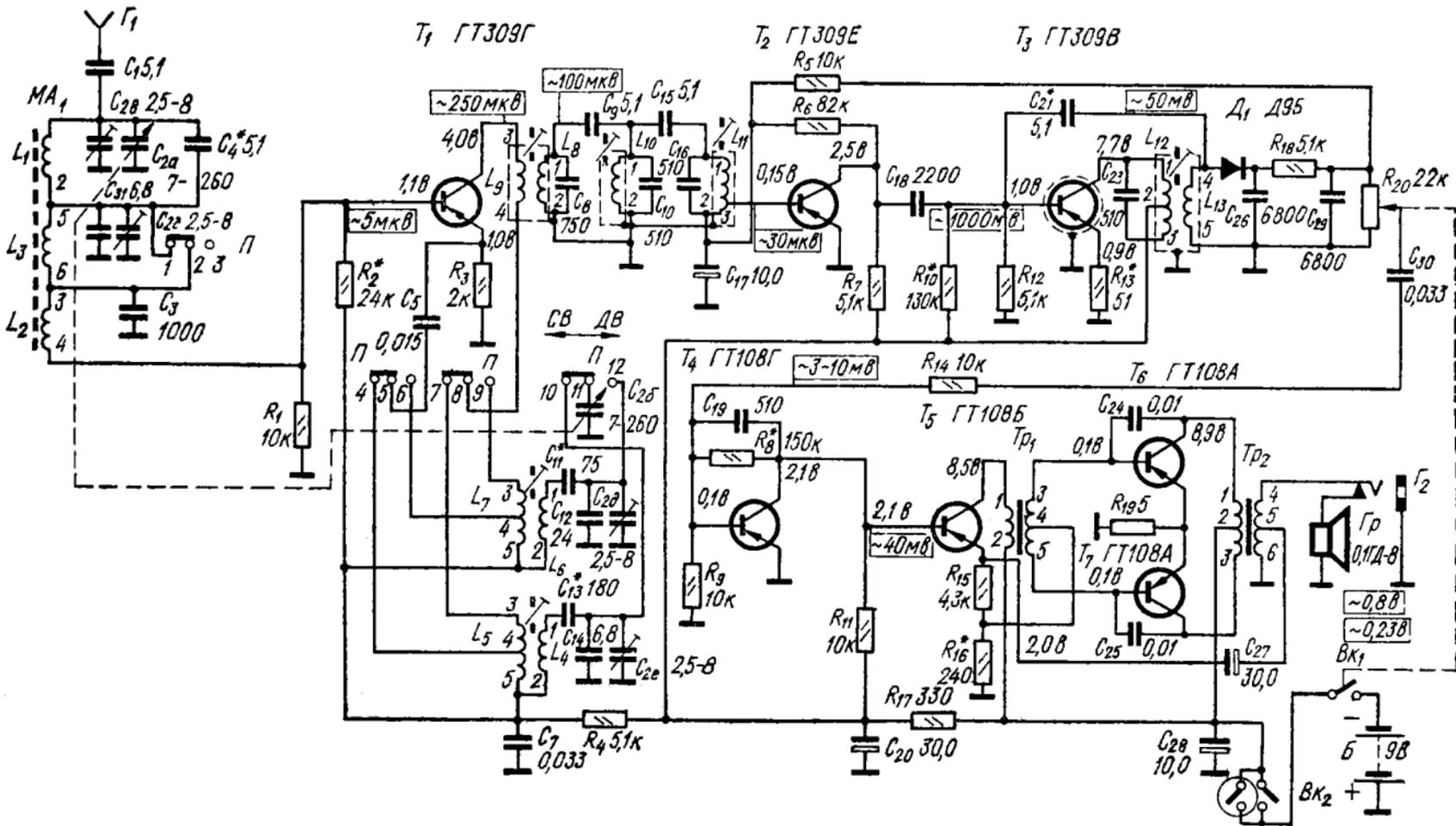
Принципиальная электрическая схема радиоприемника "Сигнал", "Нейва-М"
