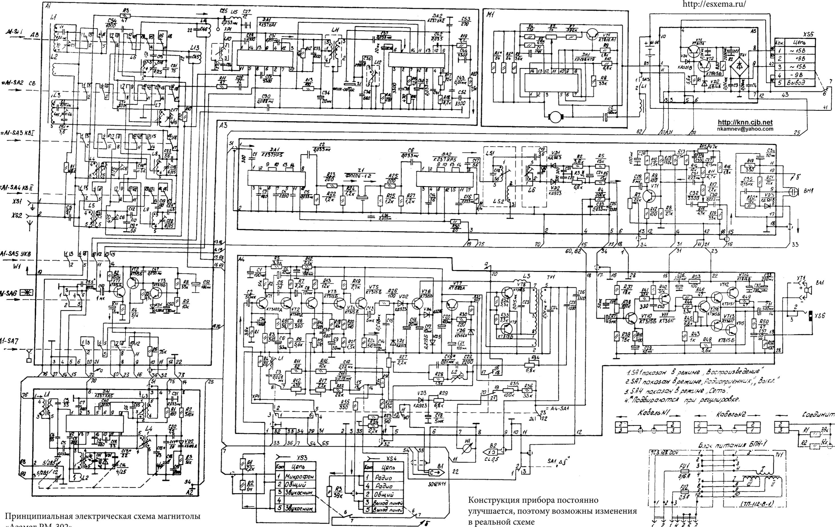
Принципиальная электрическая схема магнитофона «Азамат РМ-302»
