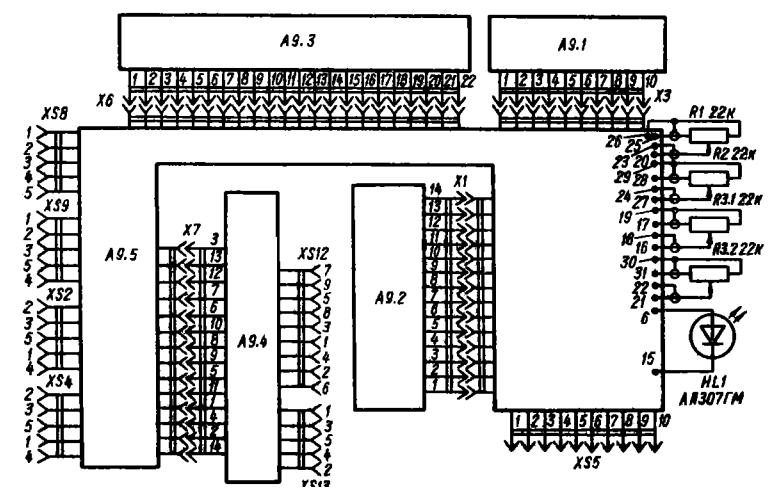
Схема соединений блока усилителя
