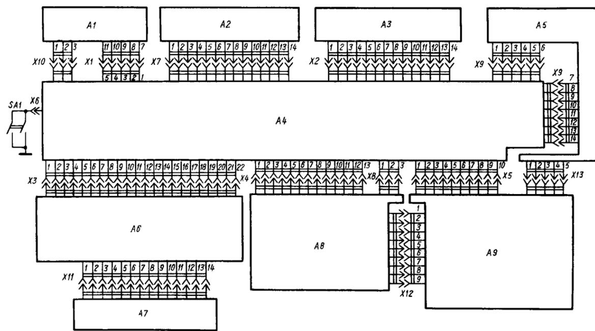
Схема соединений блоков электронной схемы управления механизмом транспортирования магнитной ленты
