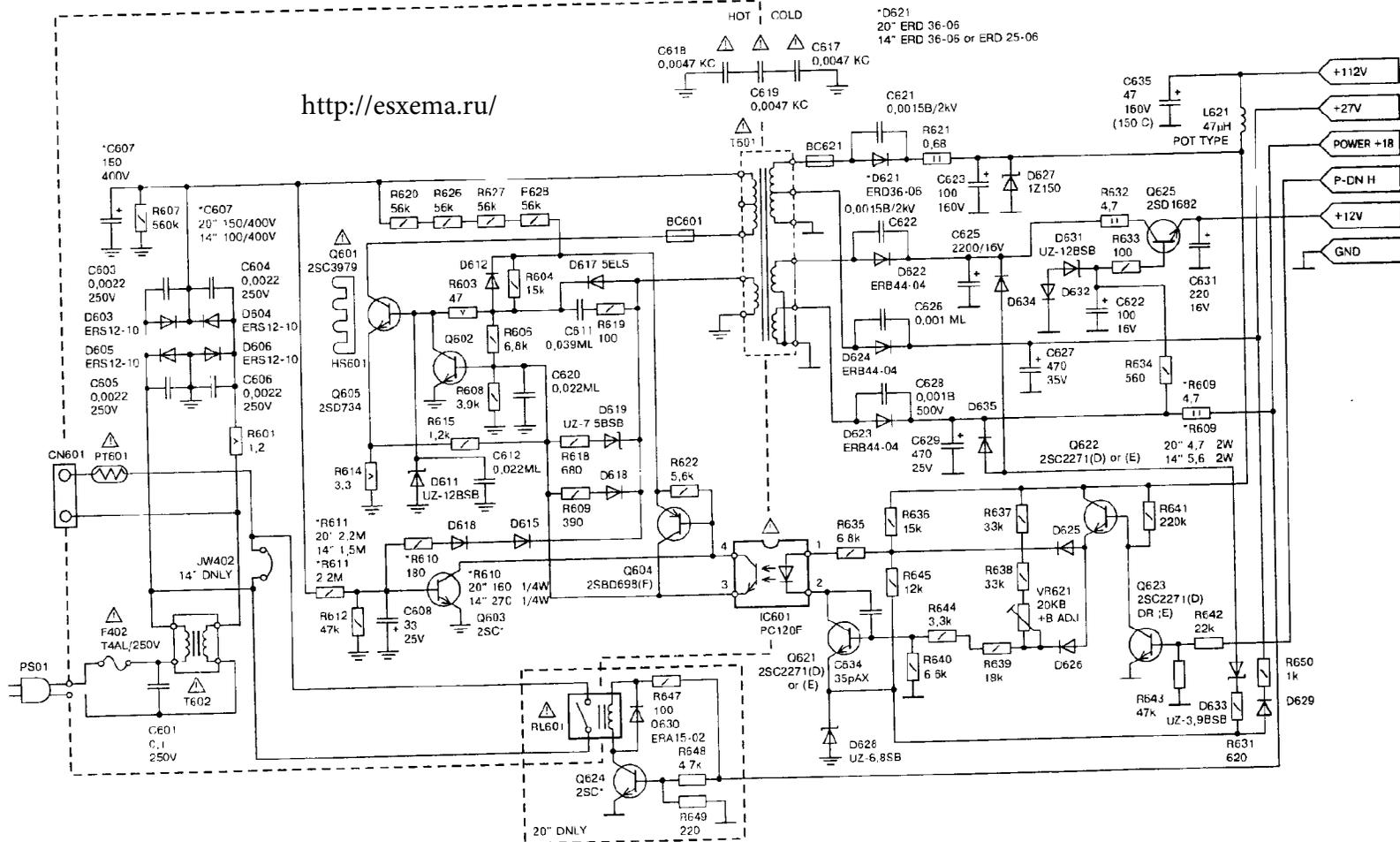
Схема источника питания для телевизора FUNAI модели TV-2000A MK8, TV-2000 MK7
